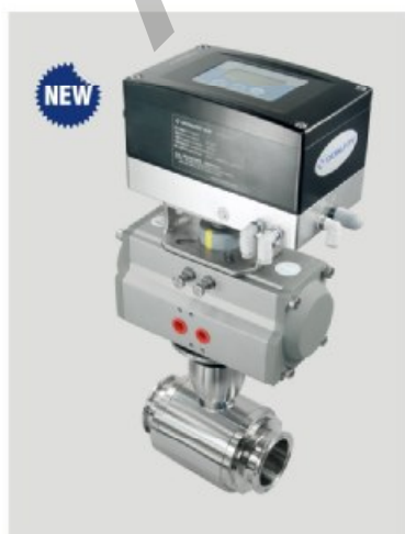
卧式气动球阀 +定位器 流量调节式球阀 输入/输出: 0/4-20mA 电源: DC24V 支持总线: DEVICE NET BUS 防护: IP67 SIZE: 1"-4", DN25-DN100 Pneumatic ball valve+ positioner Flow regulating valve input/output: 0/4-20mA 1"-4", DN25-DN100
